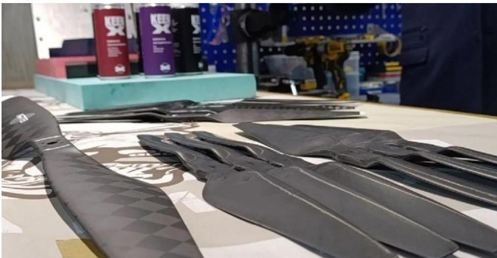
В Новосибирске организовано производство сверхлёгких деталей для БВС: воздушные винты и лопасти для БВС из сферопластика. В смолу по давно известной технологии добавляются стеклянные микросфера, масса которых намного меньше связующего в композите. Как это влияет на прочность лопастей – не сообщается.
