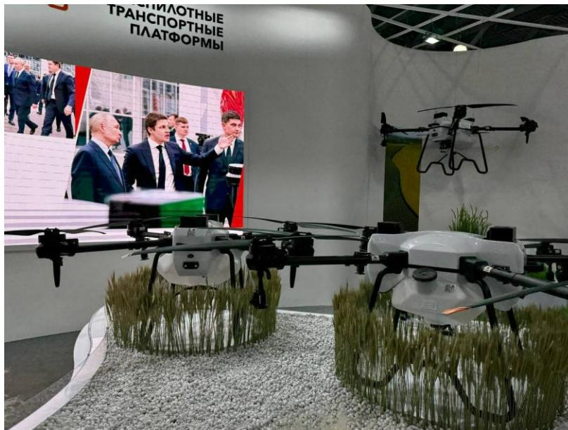
ООО "Транспорт будущего" представил агробеспилотник С-80, который предназначен для внесения удобрений и средств защиты растений. Аппарат обладает полезной нагрузкой 40 кг и способен обрабатывать до 18 га/час.
